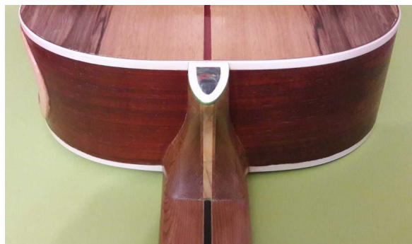
Hals, Halsfuß und der Übergang in den Zargenkranz.
