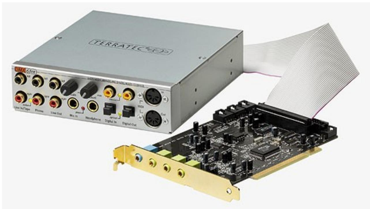
Im Erscheinungsjahr 2001, eines der best klingenden PC-Audio-Interfaces. Terratec DMX 6fire 24/96. Soundkarte die intern mit der in der Front angebrachten Break out Box verbunden wurde. Mit Werten, die sich heute noch hören lassen können.
